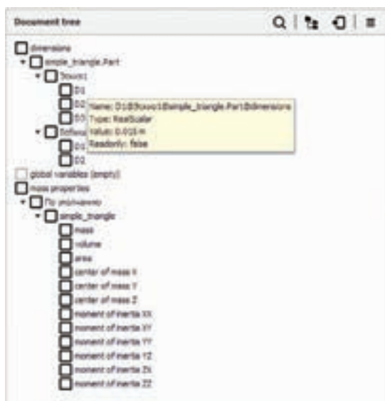
Полное дерево параметров для простой детали (одна конфигурация)
